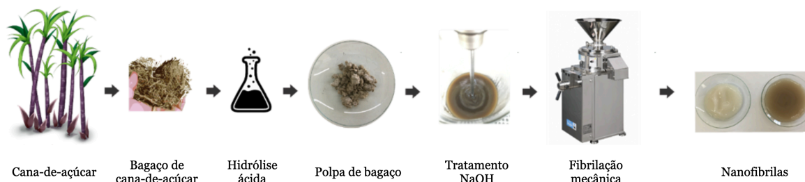
Figura 13. Esquema de preparação de nanofibrilas de celulose (branqueadas e não branqueadas) de bagaço de cana-de-açúcar utilizando moinho de pedras.
