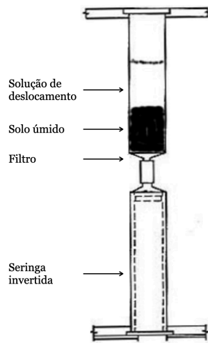
Figura 5. Esquema de montagem de coluna para extração de solução de solo.
