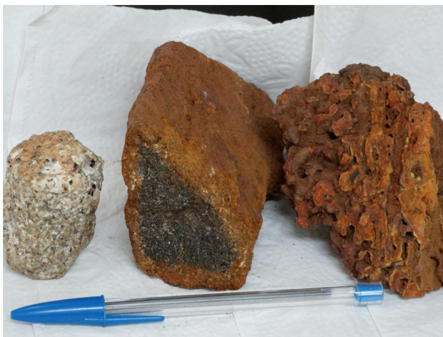
Figura 4. O efeito do intemperismo sob clima úmido na região de Lavras, sul de Minas Gerais. À esquerda, saprolito de granito (rocha pobre em Fe) mostrando coloração branca da alteração dos feldspatos em caulinita e/ou gibbsita, e tons amarelados de goethita da alteração da pouca biotita presente. Ao centro, saprolito de rocha máfica (rica em Fe) mostrando o interior inalterado e manto de intemperismo com cores indicativas de grande proporção de hematita e goethita. Assim, torna-se evidente porque os solos formados de rochas básicas tendem a ser mais vermelhos. À direita, fragmento de laterita ferruginosa, resultante de prolongada lixiviação e hidrólise, e acúmulo residual de óxidos de Fe, a partir da alteração de rocha máfica.
