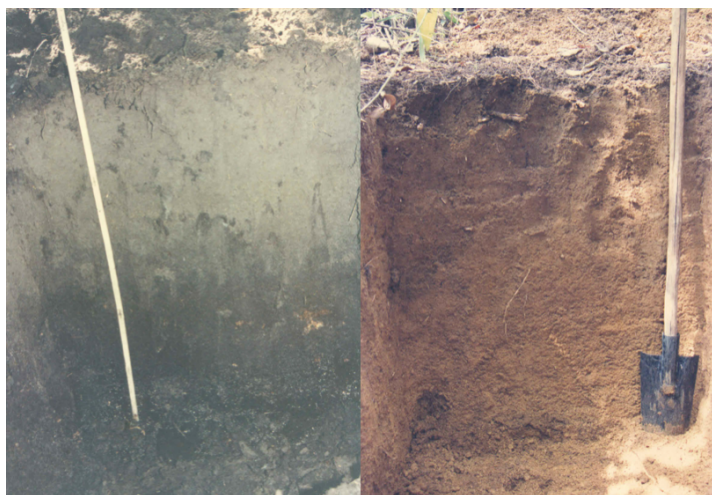
Figura 5. Horizontes de diferentes solos formados sobre ardósia, um argilito metamorfozido, em uma toposequência ao longo de uma mata de galeria no Distrito Federal. À esquerda, um Gleissolo com 2 horizontes A (A1 e A2), sendo o mais profundo com maior teor de matéria orgânica devido à lenta decomposição orgânica em anaerobiose causada pelo lençol freático subjacente. À direita, um Latossolo com horizontes A, AB e B, distante 2 km e com altitude 12 m acima. Ambos apresentam cascalho formado por fragmentos de ardósia intemperizada e de lateritas em processo de dismantelamento. Notar as diferenças de cores causadas pela remoção de óxidos de Fe no Gleissolo, que possui alta fertilidade devido ao fluxo vindo da parte alta da paisagem.
